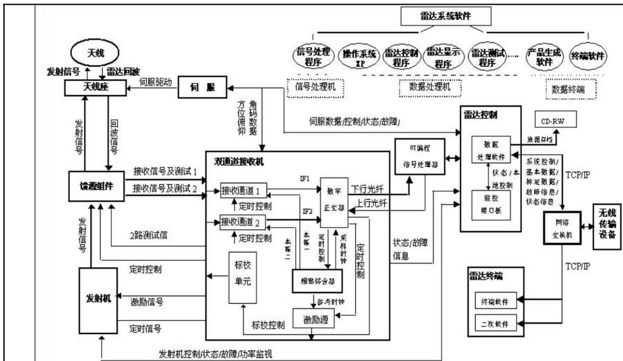
图 2-3 雷达系统信息处理流程图
