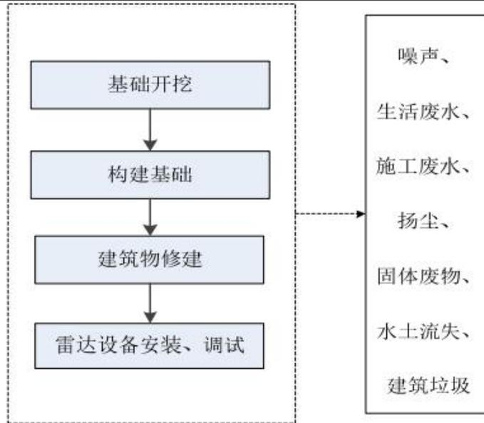
图 2-1 施工期工艺流程及产污节点图
